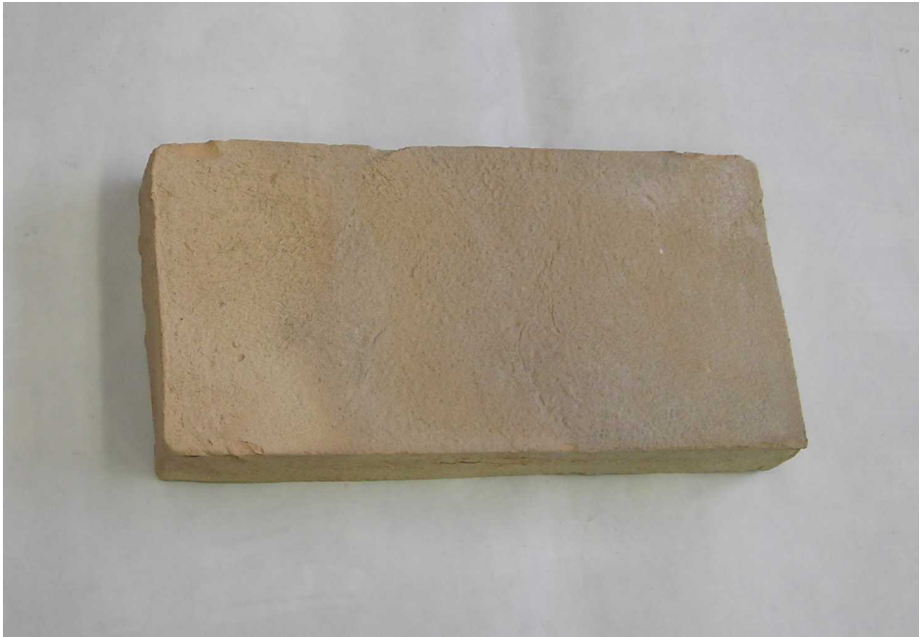
Figura 1. Riproduzione fotografica di un provino tal quale del prodotto “ Mattone Rettangolare in Cotto fatto a Mano ”.
